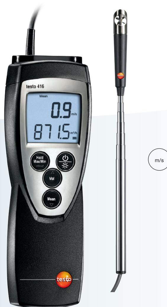
El testo 416 es un anemómetro compacto provisto de una sonda de molinete conectada de forma fija. Con su empuñadura telescópica (longitud máx. 890 mm, diámetro 16 mm), el instrumento es especialmente ideal para medición de caudal en conductos. El caudal se visualiza directamente en la pantalla.
